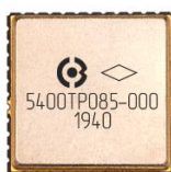
Рисунок 1. Внешний вид микросхемы 5400TP085 в корпусе 5142.48-А
